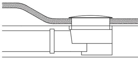
Ablauf über dem Bodenaufbau
