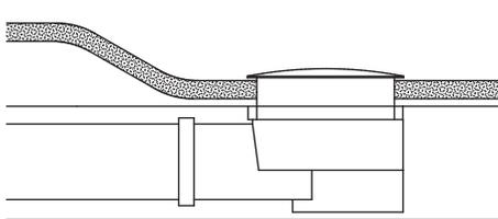
Ablauf im Bodenaufbau
