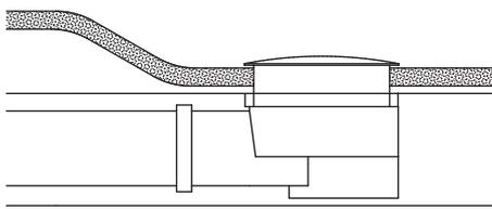
Ablauf im Bodenaufbau
