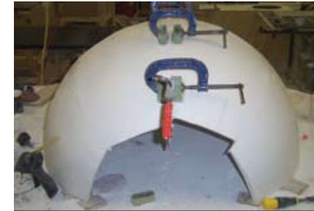
Montage von zwei Viertel-elementen zu einer halben Muschel
