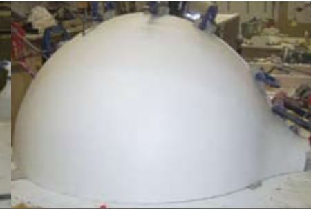
Montage von zwei Viertel-elementen zu einer halben Muschel
