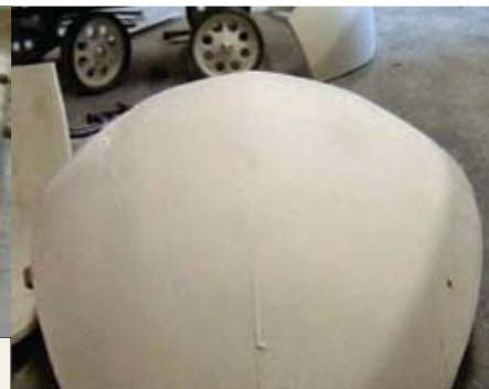
Verkleben von zwei Teilen zu einem Viertel-element
