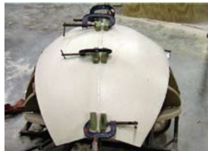
Verkleben von zwei Teilen zu einem Viertel-element
